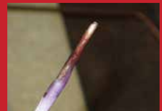
Рисунок 6: Подгорание флюсового покрытия прутка конкурента
